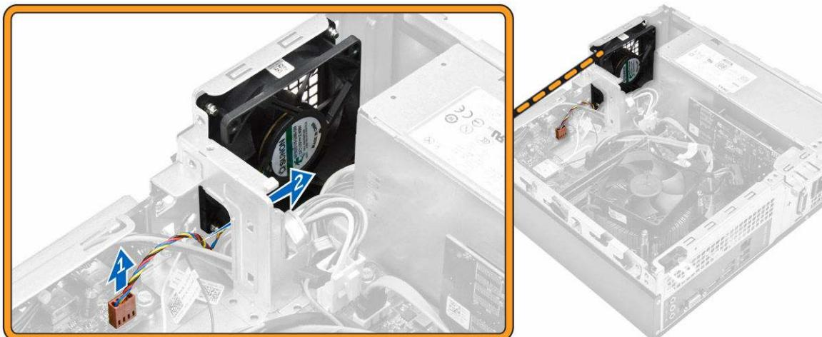
4. Demontujte skrutky upevňujúce ventilátor systému k šasi počítača a následne ho vyberte z počítača. [1, 2]
