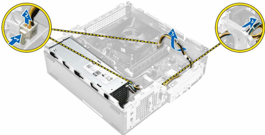
4. Führen Sie folgende Schritte durch, um das Netzteil (PSU) auszubauen:
