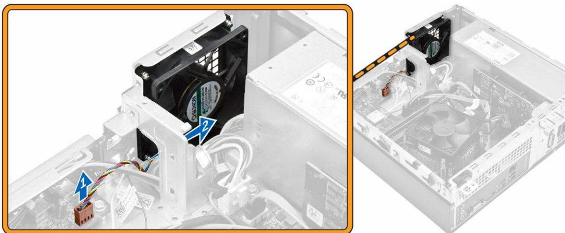
4. Vyjměte šrouby upevňující systémový ventilátor k šasi počítače a vyjměte ho z počítače [1,2].
