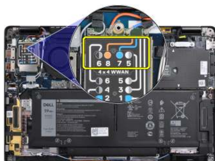
Tabuľka2. Návod na pripojenie anténnych káblov karty WWAN
