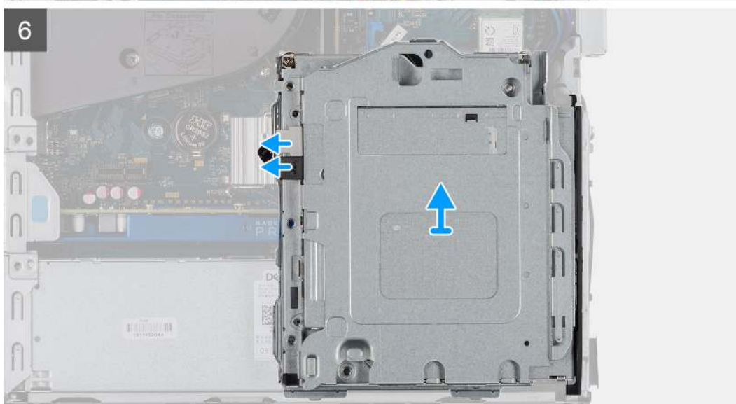
Demontáž optické jednotky
